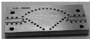
Mehrlagenaufbau mit Vias
