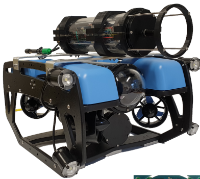
Am Institut eingesetzter Tauchroboter (oben) mit selbstentwickeltem ahoi Akustik-Modem (rechts).
